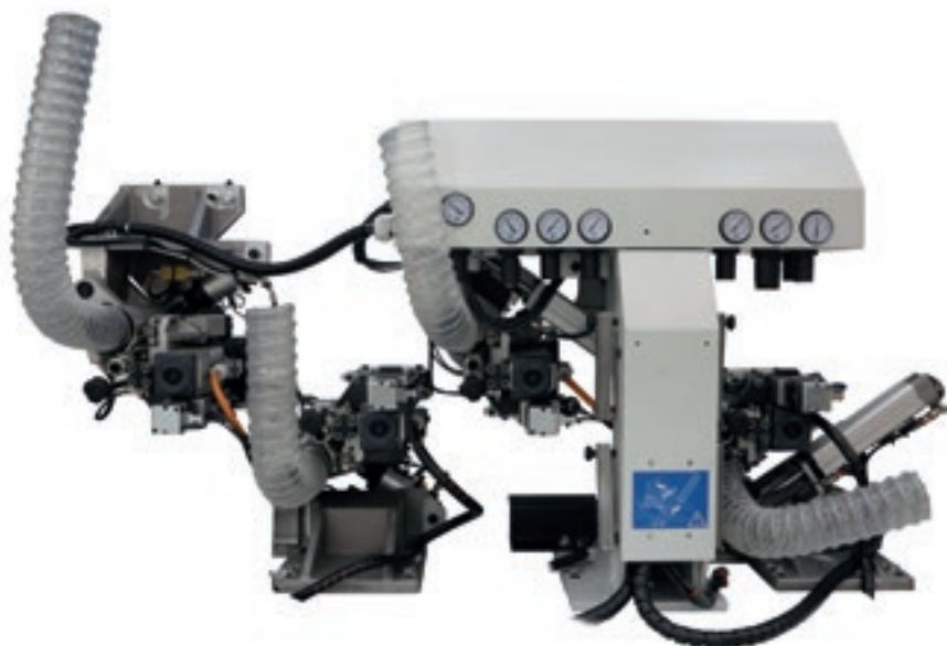
AR34 四电机气动跟踪圆角装置。非常适合磨圆木材边缘。
